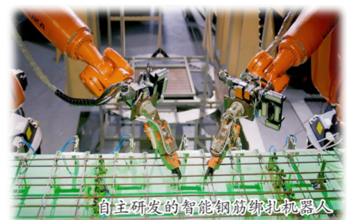
自主研发的智能钢筋绑扎机器人
